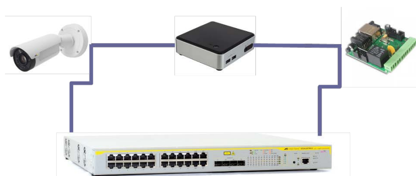
Fig. 3.3. Arhitectura sistemului LPR
